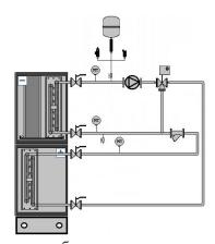
В качестве теплообменников применяется пара (водяной нагреватель и охладитель). Со стороны вытяжки предусмотрена система отвода конденсата. Возможна так же поставка
