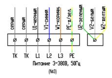
У всех трехфазных и некоторых однофазных двигателей провода от термозащитного реле выведены на клеммную колодку. Термозащита представляет из себя термоконтакт, свободный от напряжения, и размыкающийся при перегреве двигателя. Данный контакт необходимо подключить по схеме с подхватом в разрыв управляющей цепи магнитного пускателя вентилятора. При этом необходимо убедится, что при размыкании термоконтакта вентилятор отключится и не включится до вмешательства оператора.
